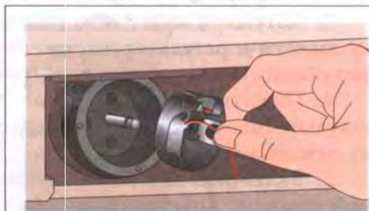
Рис. 73. Установка шпульного колпачка в челночное устройство
